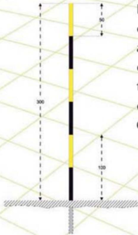
Realizzate in pvc oppure in lega di alluminio o in ferro, con fasce rifrangenti, come previsto dalla fig. 465 del Codice della Strada.
