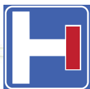
fig. 311 preavviso di strada senza uscita
