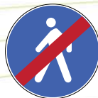
fig. 89 fine del percorso pedonale
