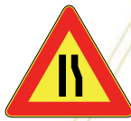
fig. 386 strettoia asimmetrica a destra
