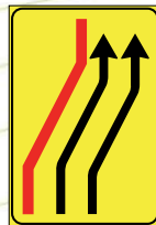
fig. 411/d segnale di corsie chiuse
