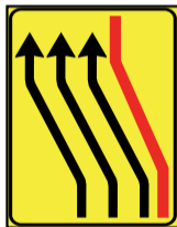
fig. 412/f segnale di rientro in carreggiata
