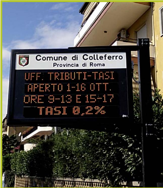
Pannello a messaggio variabile alfanumerico con 4 righe per 16 o 20, caratteri altezza 100 mm. LED ad alta luminosità di colore ambra.
