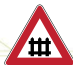
fig. 8 passaggio a livello con barriere
