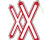
fig. 10/d doppia Croce di S. Andrea installata verticalmente
