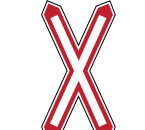
fig. 10/c Croce di S. Andrea installata verticalmente
