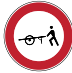
fig. 57 transito vietato ai veicoli a braccia
